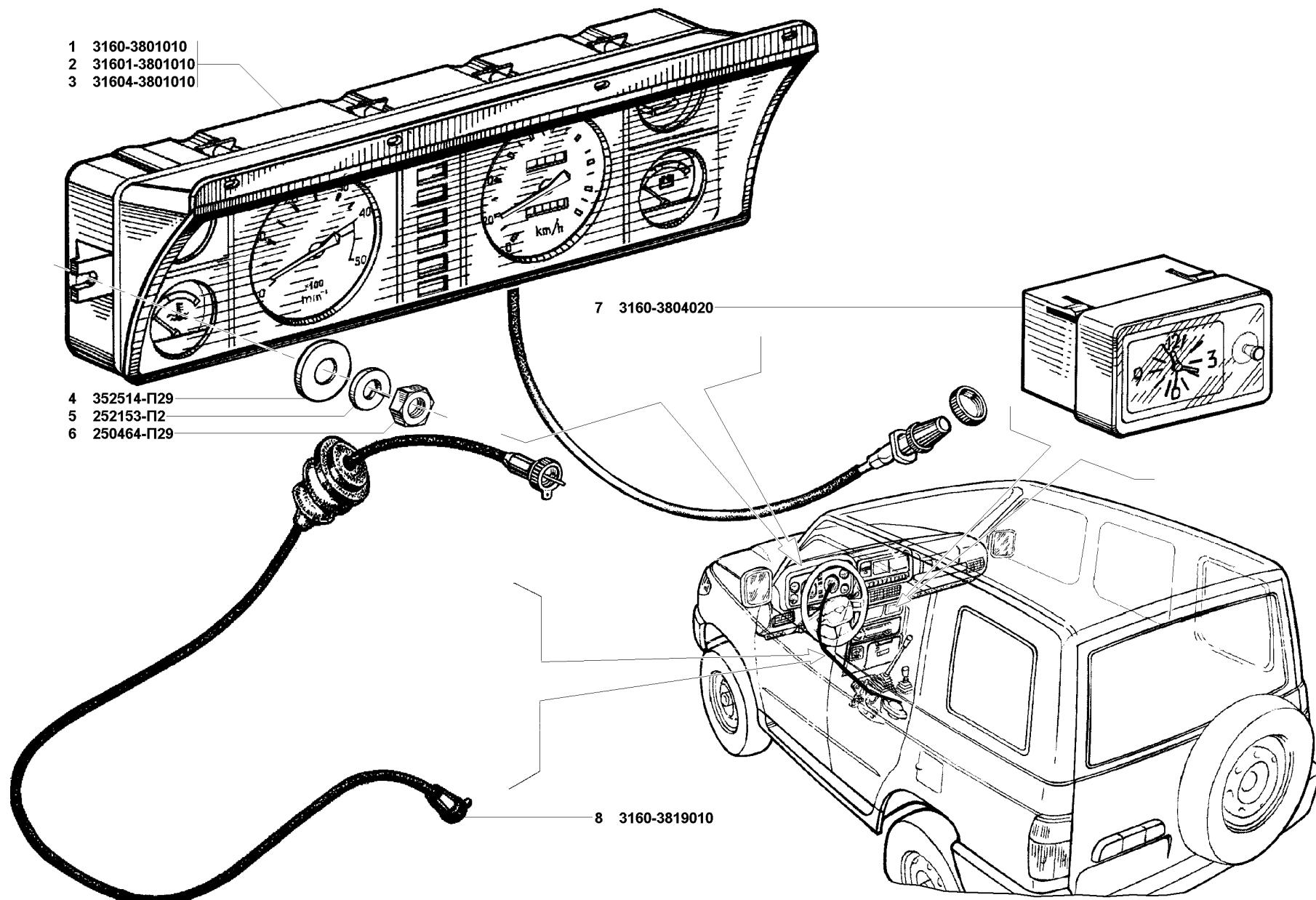
Рис. 103. Комбинация приборов (3801), часы (3804), вал гибкий спидометра (3819)
